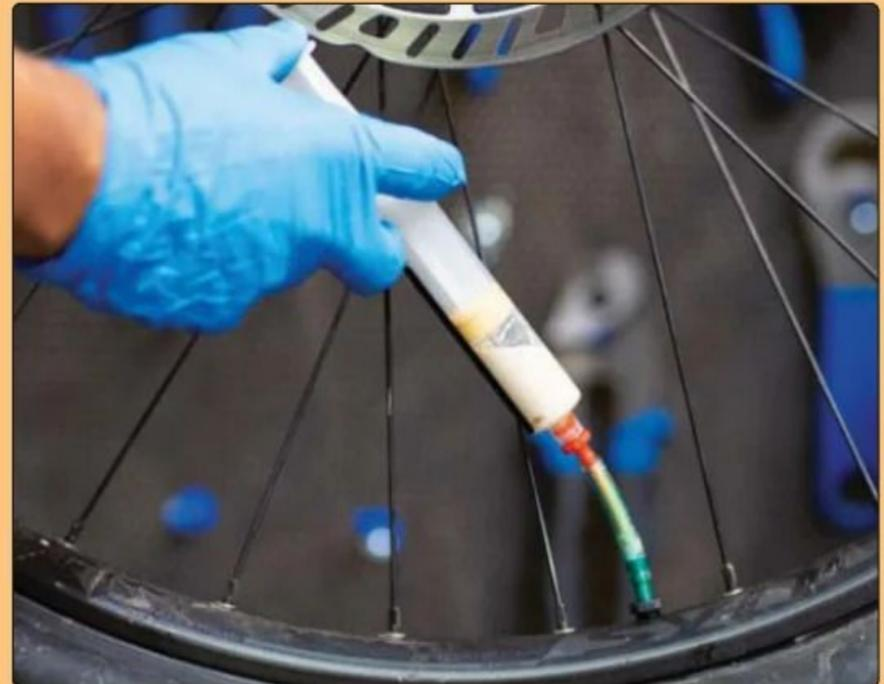
**PASO 14>** Saca el aire y reintroduce el sellante. Vittoria recomienda añadir entre 90 y 120 ml de líquido sellante para neumáticos entre 27,5x2.40" y 29x2.60".
