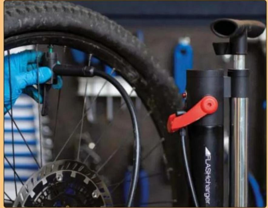
**PASO 12>** Con la bomba de taller normal debería talonar, pero si no lo consigues, tendrás que recurrir a una bomba con depósito, un compresor o probar con unas botellas de Co<sup>2</sup>.
