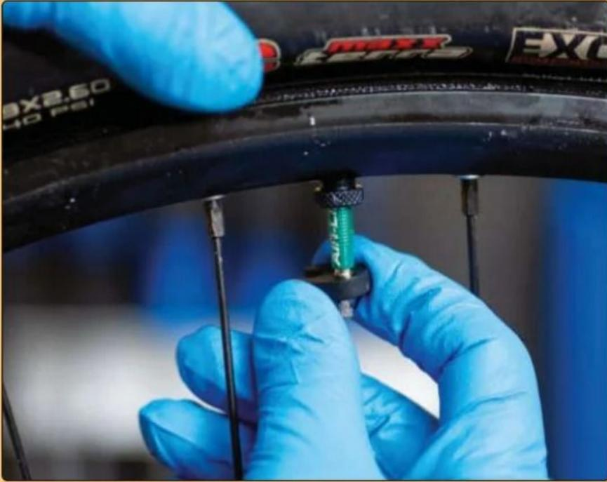
**PASO 11>** Si has llegado hasta aquí, el resto está chupado. Desmonta el obús de la válvula para que entre todo el caudal de aire posible y hacer un talonado rápido.
