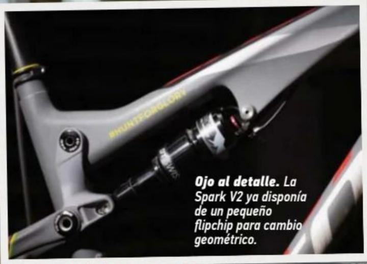
Ojo al detalle. La Spark V2 ya disponía de un pequeño flipchip para cambio geométrico.
