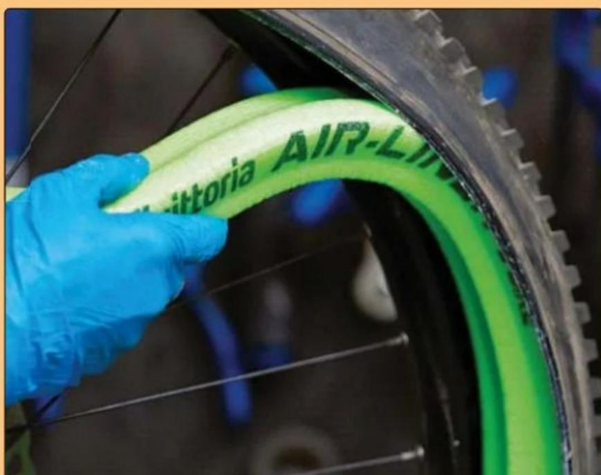
**PASO 7>** Verás que el mousse Vittoria tiene perfil en "V". La parte estrecha de la "V" hay que ponerla hacia la llanta, y la más abierta hacia el neumático.
