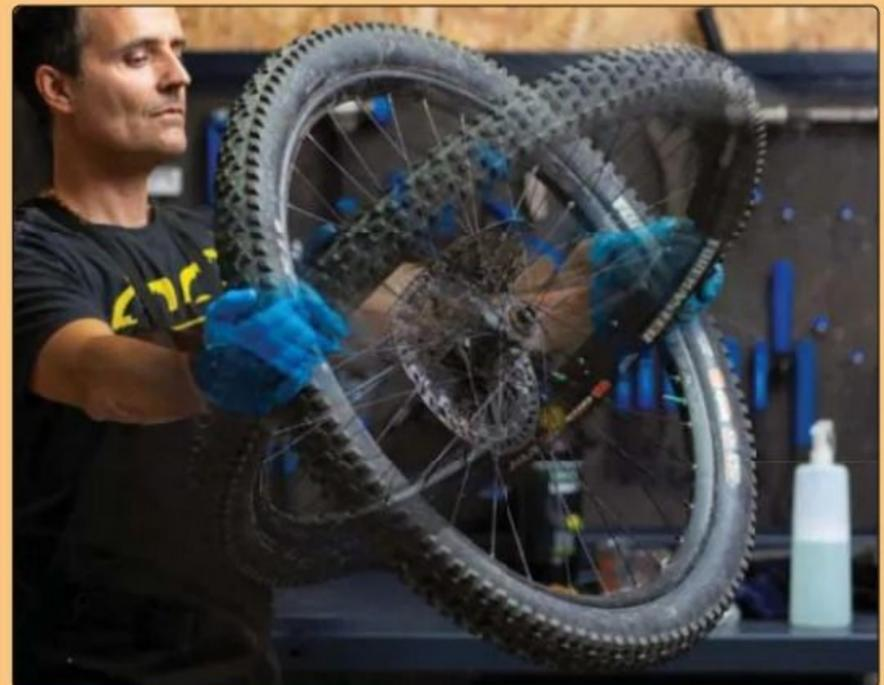
**PASO 16>** Agita la rueda y hazla girar para repartir el líquido sellante por todo el interior. Si es posible, sal a dar una vuelta corta, con moderación, para lograr un sellado efectivo.
