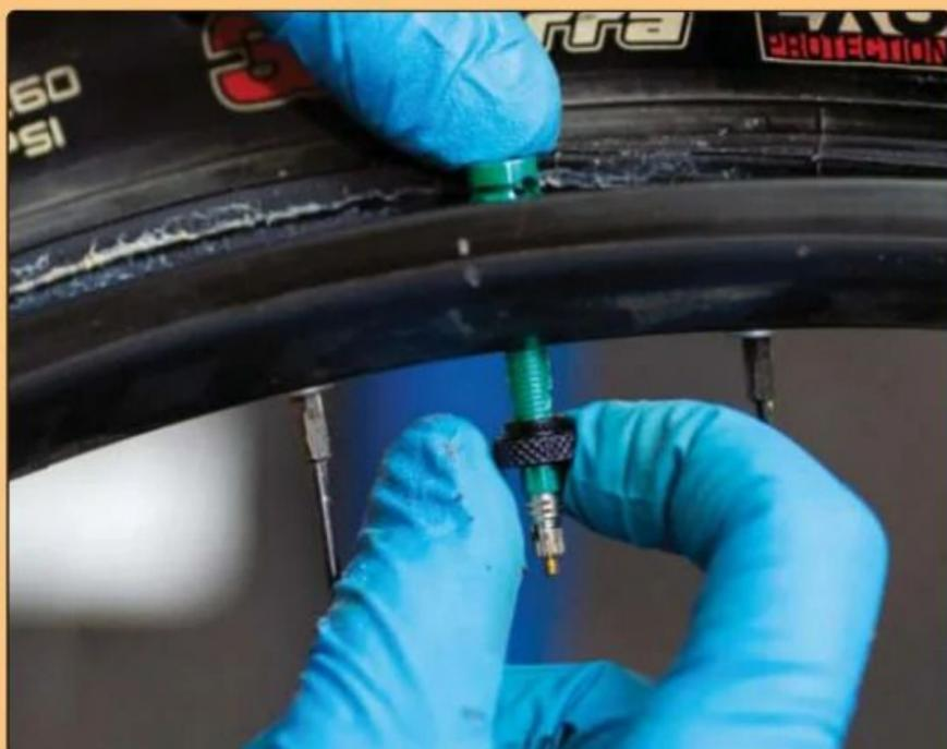
**PASO 5>** Revisa a conciencia el fondo de llanta, sobre todo, el agujero para la válvula debe estar en buen estado. Después instala la válvula Vittoria suministrada con el mousse.
