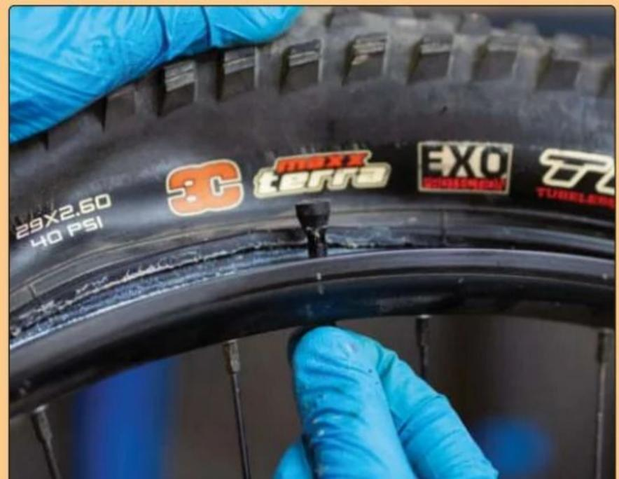
**PASO 4>** Ahora es el momento de desmontar la válvula que actualmente tienes en la llanta. Retira la tuerca de fijación y la junta tórica, y empuja la válvula desde el exterior hacia el interior.
