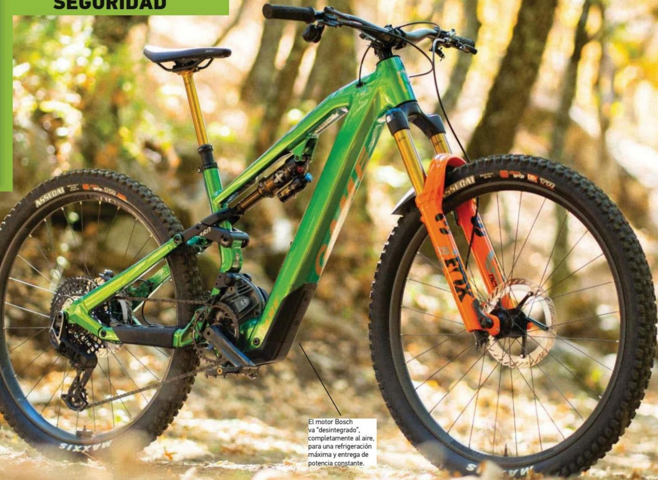
El motor Bosch va "desintegrado", completamente al aire, para una refrigeración máxima y entrega de potencia constante.
