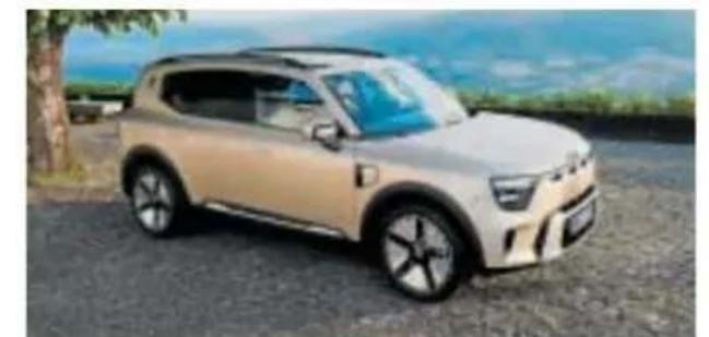
**FICHA TÉCNICA Motores:** eléctrico de 340-646 CV **Largo/ancho/alto (m):** 4,69/1,92/1,70 **Maletero:** 630 litros **Consumo:** desde 18,4 kWh/100 km **Aceleración:** de 0 a 100 km/h en 3,8 segundos **Velocidad máxima:** 210 km/h **Precio:** desde 46.790 €
