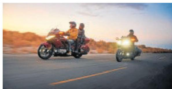
**FICHA TÉCNICA Motor:** 6 cilindros, 1.833cc **Potencia:** 126 CV a 5.500 rpm **Par motor:** 170 Nm a 4.500 rpm **Consumo:** 5,4 l/100 km **Altura del asiento:** 745 mm **Peso en orden de marcha:** 373 kg **Precio:** gama de 2024 desde 41.000 euros
