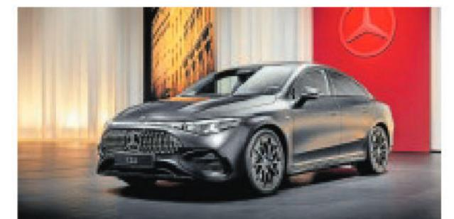
**FICHA TÉCNICA Motores:** eléctrico e híbrido de 272-354 CV **Largo/ancho/alto (m):** 4,72/1,85/1,46 **Maletero:** 506 litros **Consumo:** 12,2 kWh/100 km **Autonomía:** 771 km **Velocidad máxima:** 210 km/h **Precio:** no facilitado. Gama actual desde 43.700 euros
