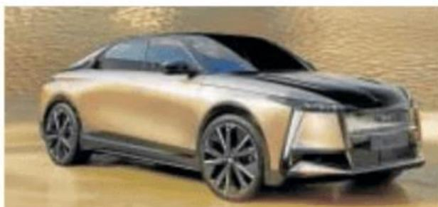
**FICHA TÉCNICA Motores:** eléctricos de 260, 280 y 375 CV **Largo/ancho/alto (m):** 4,82/1,90/1,58 **Maletero:** 620 litros **Autonomía:** hasta 750 km **Aceleración:** de 0 a 100 km/h en 5,4 segundos **Velocidad máxima:** 190 km/h **Precio:** no disponible
