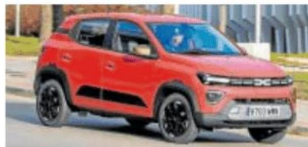
**FICHA TÉCNICA Motores:** eléctricos de 45 y 65 CV **Largo/ancho/alto (m):** 3,70/1,58/1,51 **Maletero:** 288 litros **Autonomía:** 228 km **Aceleración:** de 0 a 100 km/h en 13,7 segundos **Velocidad máxima:** 125 km/h **Precio:** desde 17.890 euros
