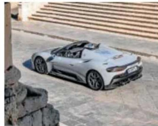
**FICHA TÉCNICA** Motores: gasolina de 630 CV Largo/ancho/alto (m): 4,66/1,96/1,21 Maletero: desde 150 litros Consumo: desde 11,2 l/100 km Velocidad máxima: 320 km/h
