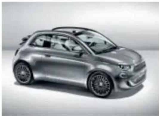
**FICHA TÉCNICA** Motores: gasolina y eléctrico de 95 a 179 CV Largo/ancho/alto (m): 3,57/1,62/1,48 Maletero: 185 litros Consumo: desde 4,6 l/100 km y 13 kWh/100 km V. máxima: 225 km/h
