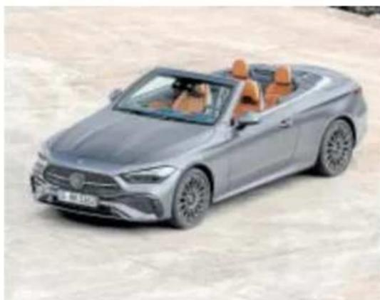
**FICHA TÉCNICA** Motores: diésel, gasolina e híbrido de 200 a 258 CV Largo/ancho/alto (m): 4,85/1,86/1,42 Maletero: 385 litros Consumo: desde 4,9 l/100 km Velocidad máxima: 250 km/h
