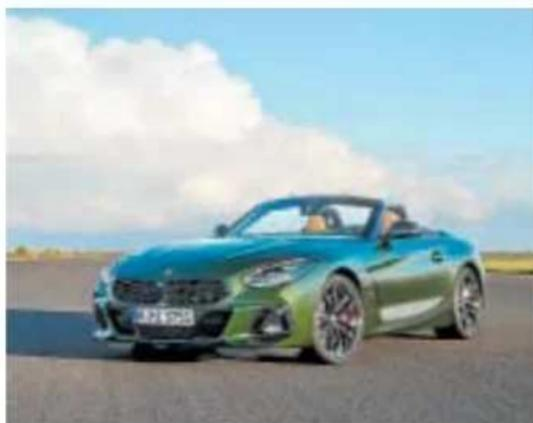
**FICHA TÉCNICA** Motores: gasolina de 197 a 340 CV Largo/ancho/alto (m): 4,32/1,86/1,30 Maletero: desde 281 litros Consumo: desde 7,1 l/100 km Velocidad máxima: 250 km/h
